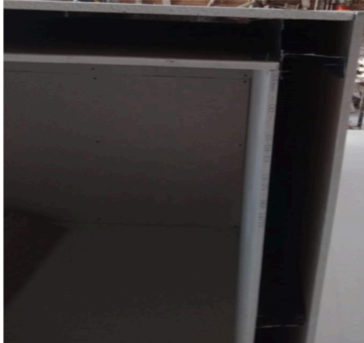
Figura 3 - Cubo com isolação poliestireno expandido.
